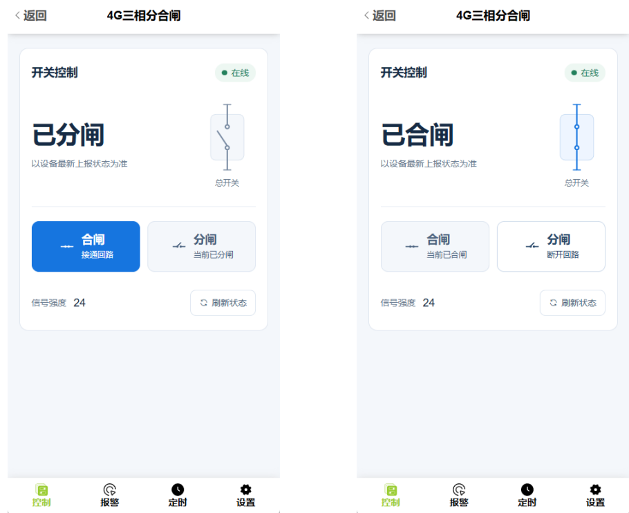
手机端控制界面 左为已分闸 右为已合闸
